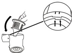
7. Vuelva a colocar la tapa protectora del depósito de polvo como se indica a seguir
