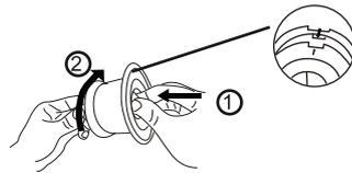
7. Setzen Sie die Filterhülle zurück in den Staubbehälter ein, wie es unten angezeigt ist.
