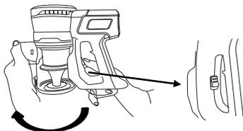
2. Haal de filterbehuizing eruit, en verwijder het filter
