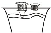
4. Si prega di asciugare completamente il filtro HEPA e la scatola filtro prima di assemblarli nuovamente
