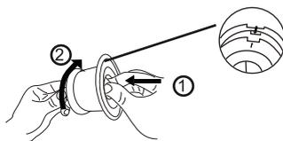
6. Coloque el embudo del filtro nuevamente en el depósito de polvo
