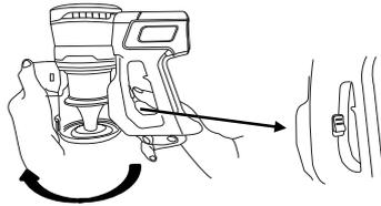
3. Entnehmen Sie die Filterhülle, dann entnehmen Sie den Filter
