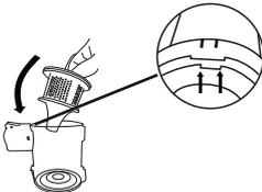
8. Montieren Sie den Staubschutz in den Staubbehälter, wie es unten angezeigt ist.
