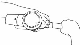
2. Entriegeln Sie die Staubbehälter-Sperre
