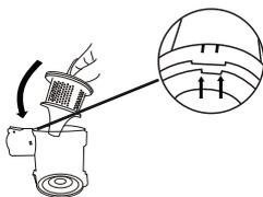
7. Assembler le réservoir dans le sens inverse des aiguilles d'une montre
