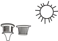
6. Nach dem Trocknen, montieren Sie den Filter zurück in die Hülle
