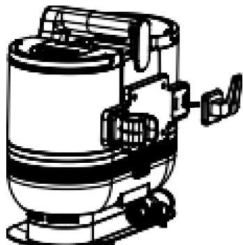
3. Ziehen Sie die Halterung vom Griff ab und lassen Sie sie auf der linken Seite der hinteren Abdeckung einrasten.
