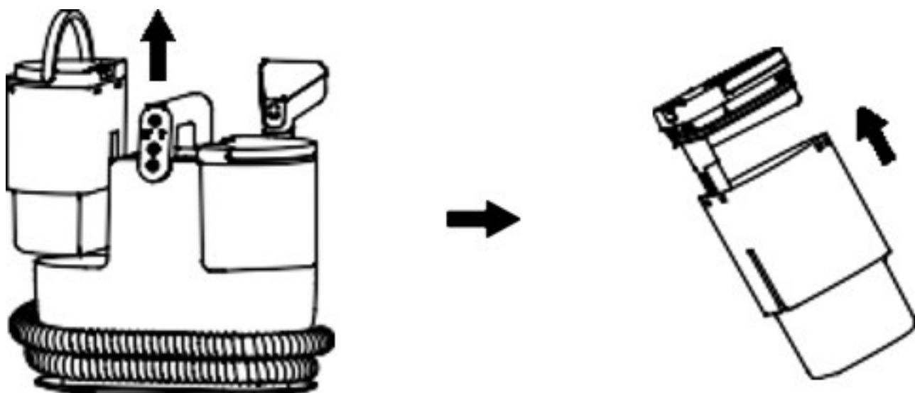
Adicione água ao tanque de água limpa: Quando o tanque de água limpa ficar sem água, adicione água a tempo :
