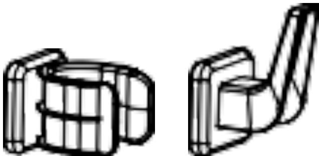
2. Entfernen Sie den Aufhängehaken und befestigen Sie ihn an der rechten Seite der hinteren Abdeckung.
