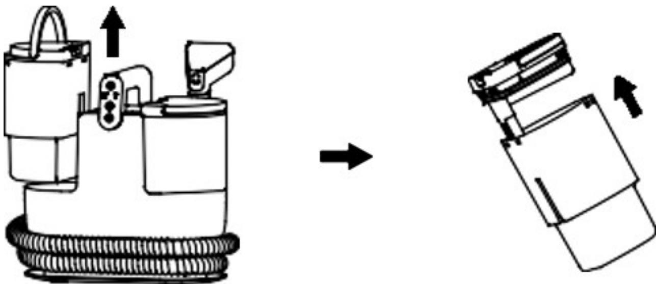
Aggiungere acqua al serbatoio dell'acqua pulita: quando il serbatoio dell'acqua pulita si esaurisce, si prega di aggiungere acqua in tempo : .
