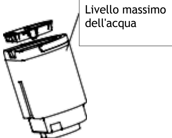
8. Installare il serbatoio dell'acqua pulita nel corpo.
