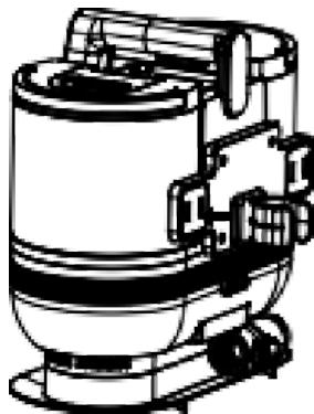
4. Verwijder de slangconnector, lijn het gat in de slangbocht uit met de achterkant van de basis, steek hem er stevig in en hoor een "plop".
