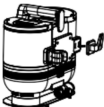
3. Retirer le support de la poignée et l'enclencher sur le côté gauche du couvercle arrière.
