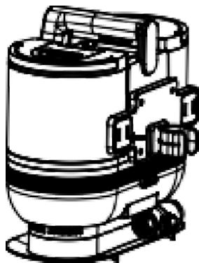
4. Entfernen Sie den Schlauchanschluss, richten Sie das Loch im Schlauchbogen an der Rückseite der Basis aus, führen Sie ihn fest ein und hören Sie ein "Plopp".
