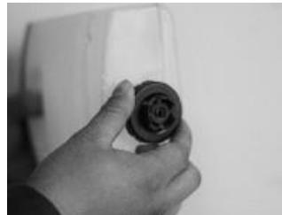
Dévissez le filtre du réservoir en vissant dans le sens contraire des aiguilles d'une montre ;
