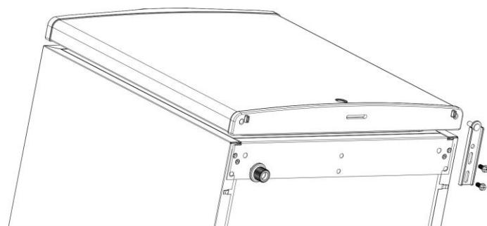
Schritt 3: Verschieben und befestigen Sie das untere Türscharnier einschließlich der Füße mit den Schrauben.
