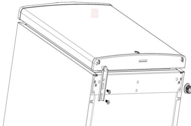
Étape 4 : Retirez et déplacez la charnière supérieure et le couvercle. Fixez la charnière supérieure de la porte avec les vis, et recouvrez avec le couvercle en plastique et le couvercle de la charnière.
