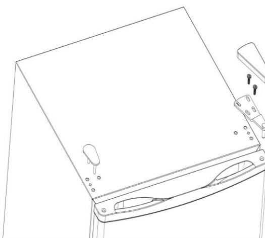
Paso 2: Desmonte la bisagra inferior de la puerta y los pies aflojando los tornillos.
