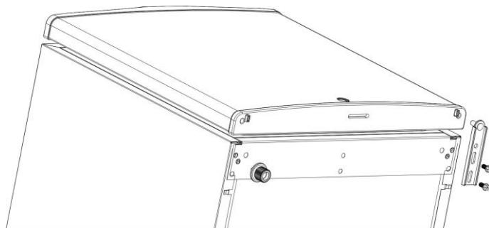
Passaggio 3: spostare e fissare la cerniera inferiore della porta compresi i piedini con le viti.
