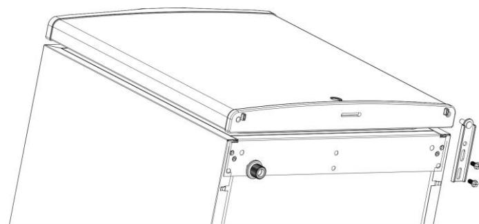
Paso 3: Desplace y fije la bisagra inferior de la puerta, incluidas las patas, con los tornillos.
