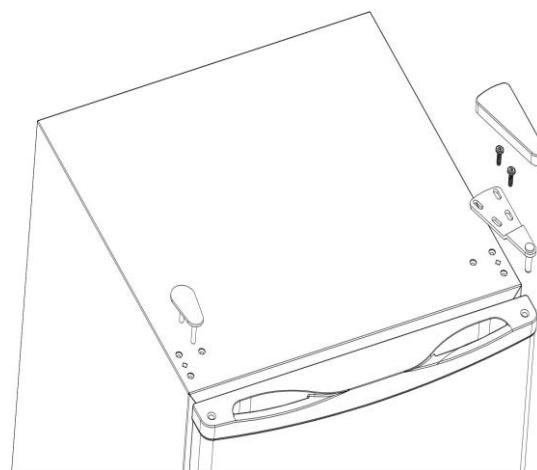
Schritt 2: Demontieren Sie das untere Türscharnier und die Füße, indem Sie die Schrauben lösen.
