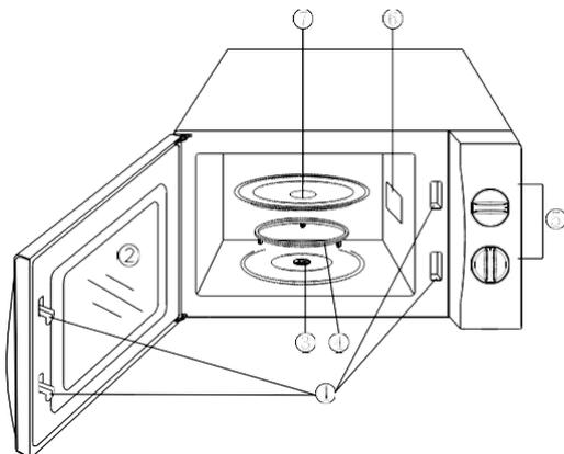
1. Porte munie d'un système de verrouillage
