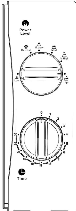
Le panneau de contrôle possède deux molettes. L'une règle la minuterie et l'autre la puissance.
