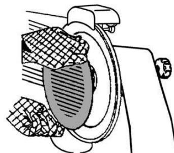
Si el carro deslizante deja de deslizarse con facilidad, coloque la rebanadora de costado. Limpie la barra guía de deslizamiento (29) y lubríquela con vaselina o aceite lubricante industrial.
