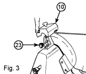
NB: il faut noter que la lame est très résistante, par conséquent elle doit être affûtée uniquement lorsque la capacité de coupe diminue. La plaque de jauge ou la plaque de protection de la trancheuse doit être fermée par mise en place de l'aiguiseur intégré pendant l'affûtage.
