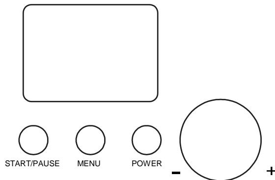
**[POWER]** : Nach dem Starten geht das Gerät in den Standbymodus über. Drücken Sie dann den Knopf **[POWER]** um in den Einstellungsmodus überzugehen und auf dem LCD Display wird "60 : 00" erscheinen. Drücken Sie den Knopf **[POWER]** um wieder zum Standbymodus überzugehen.
