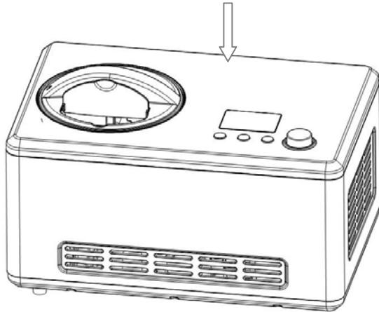
**Paso 10.** Después de que el proceso ha terminado, apague la máquina, y luego saque el recipiente extraíble.
