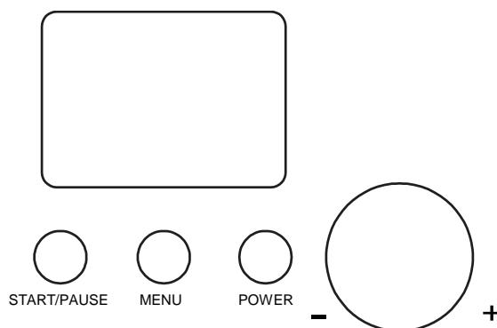
**[POWER]** : Después del encendido, la máquina entra en modo de espera. A continuación, pulse el botón **[POWER]** para entrar en el modo de ajuste y la pantalla LCD mostrará " 60:00 ". Pulse el botón **[POWER]** durante el modo de ajuste, la máquina entrará en el modo de espera de nuevo.
