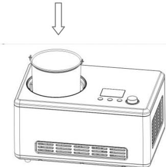
**Stap 3.** Plaats de verwijderbare kom in de machine en draai zodat deze vast klemt in het apparaat (zie afbeelding zijkant).
