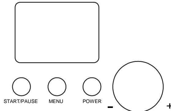
**[POWER]** : Na het inschakelen gaat de machine in stand-by modus. Druk dan de **[POWER]** knop om het apparaat in te stellen. Het LCD scherm geeft "60 : 00" aan. Druk op de **[POWER]** knop tijdens het instellen om het apparaat weer op stand-by te zetten.
