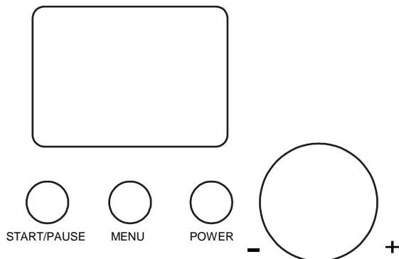
**[POWER]:** En appuyant une fois sur le bouton **[POWER]** la machine sera en Stand by, en appuyant de nouveau sur le bouton **[POWER]**, vous pouvez choisir le mode et l'écran LCD se met à clignoter et affiche "60 : 00". Si vous appuyez à nouveau sur le bouton **[POWER]** la machine se remettra en stand by.
