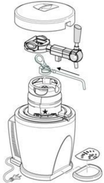
3. Als de omgevingstemperatuur 25°C is en het Heinekenvaatje is geplaatst, schakel het apparaat dan in met DC-of AC-spanning gedurende 48u, het bier zal dan een temperatuur krijgen van 3~6°C.(3°C betekent dat de
