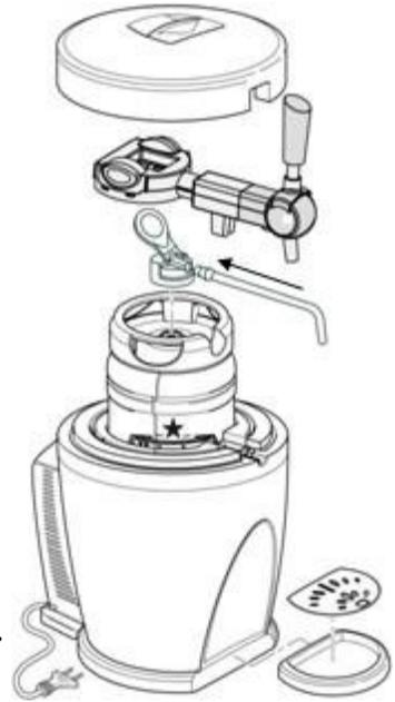
3. A una temperatura ambiente de 25 °C, una vez que coloque el tonel y encienda el aparato ya sea conectado a CD o CA, la cerveza se enfriará a 3-6 °C en 48 horas y se mantendrá siempre a esa temperatura. Si la temperatura está en 3 °C significa que el compresor está funcionando y en 6 °C significa que el compresor está parado, en modo estacionario.
