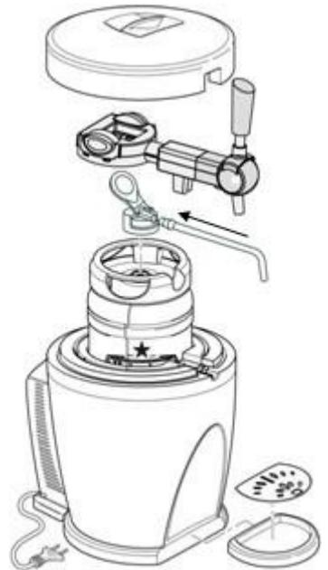
3. Wenn die Umgebungstemperatur 25°C beträgt und das Heineken-Fass eingesetzt ist, schließen Sie das Gerät an einem DC oder AC Stromkreis für 48 Stunden an, die Biertemperatur wird bei 3~6°C bleiben. (3°C bedeutet, dass der Kühler arbeitet, bei 6°C wird dieser gestoppt).
