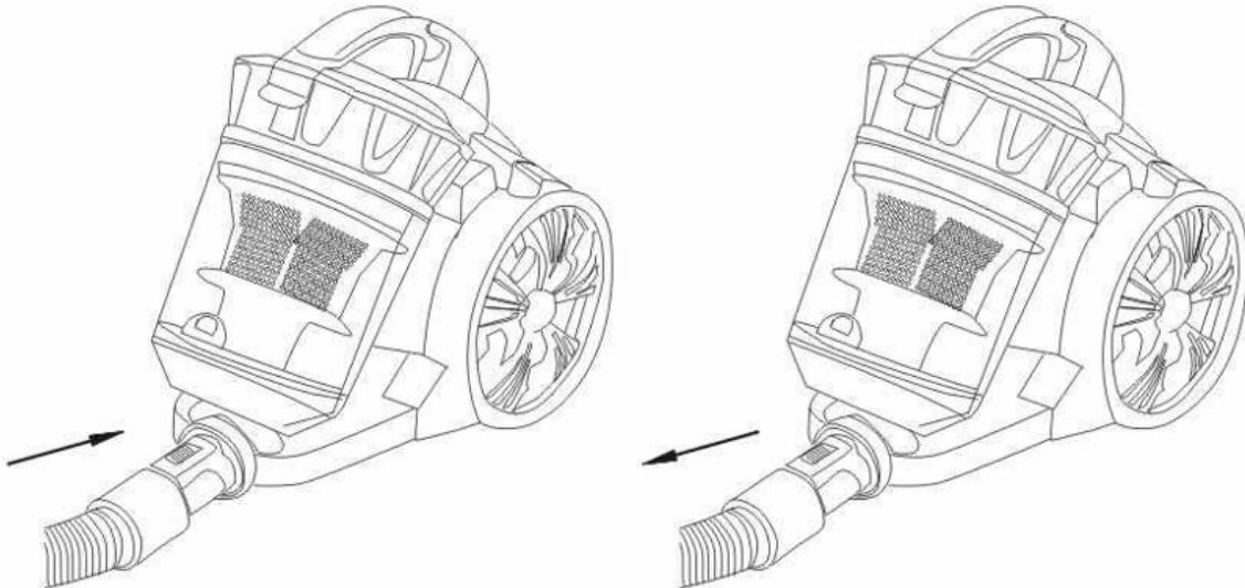
(3) Ajuste el tubo de extensión al mango del tubo y cepillo para suelo tal y como se muestra en la imagen.
