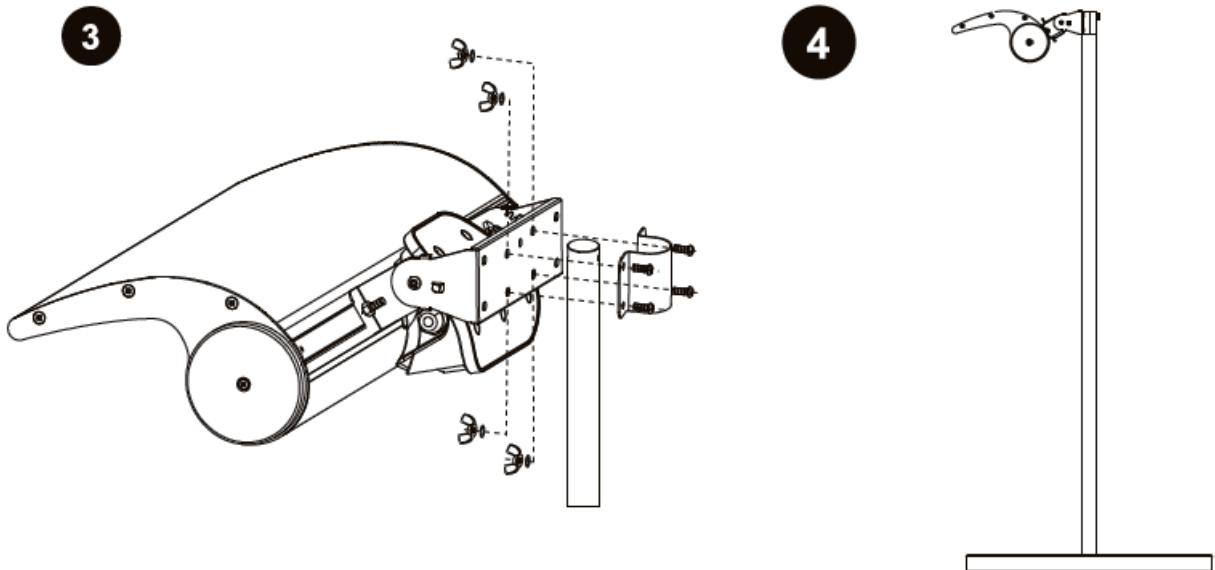
3.4 Nach der Installation und bevor Sie das Heizgerät einschalten, überprüfen Sie sorgfältig, dass das Kabel in dem Hacken auf der Rückseite des Gerätes befestigt ist. Lassen Sie das Kabel während des Betriebs nicht in Kontakt mit erhitzten Flächen kommen.
