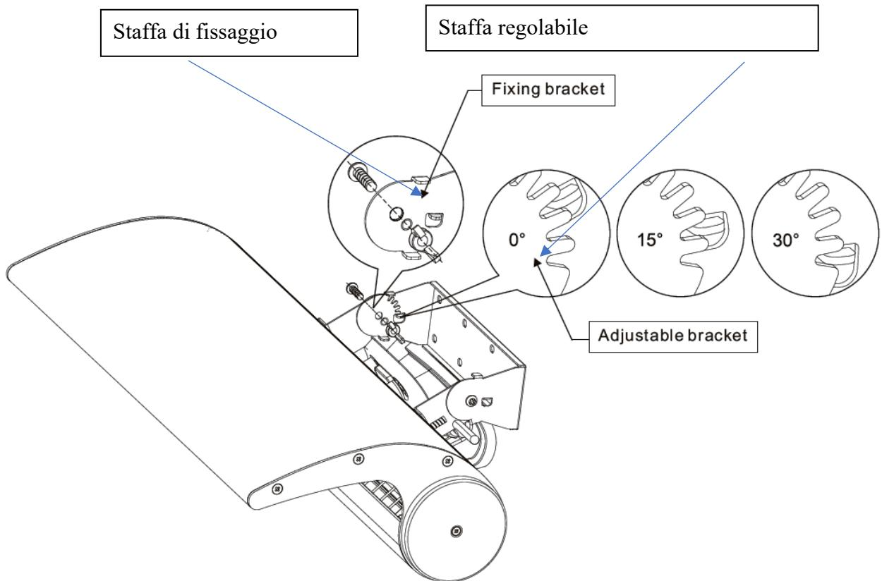
3.2 Regolare l'angolo di riscaldamento ( $0^\circ$ ,  $15^\circ$ ,  $30^\circ$ );
