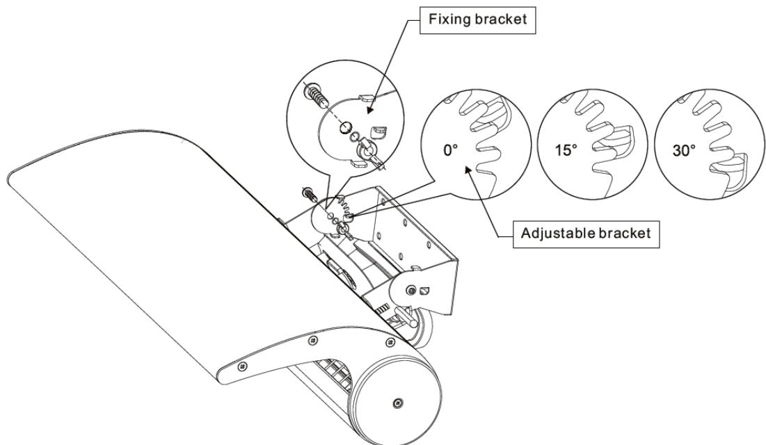
Fixing bracket : Étrier de fixation
