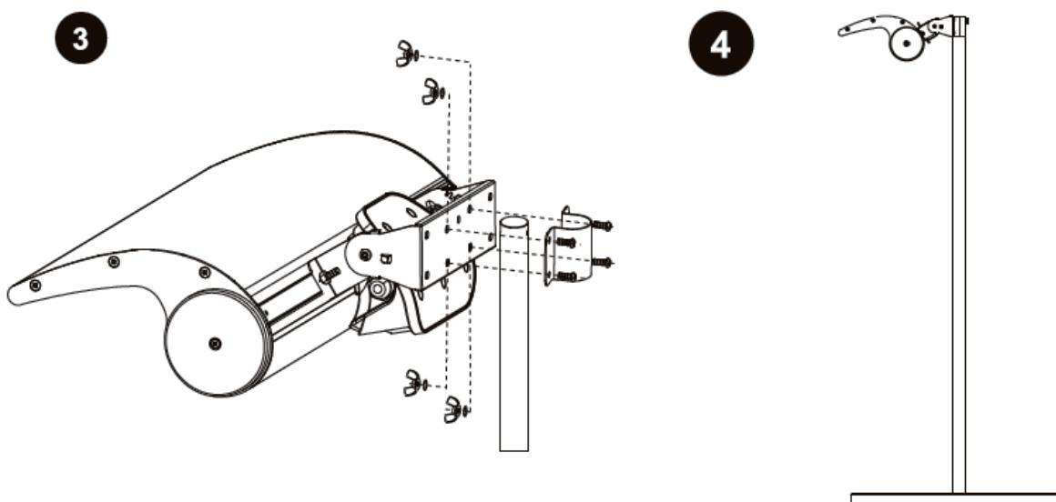
Después de la instalación y antes de encender el calentador, verifique que el cable de alimentación esté conectado firmemente al enganche en la parte posterior del calentador. No permita que el cable de alimentación entre en contacto con superficies calientes mientras el calentador esté en funcionamiento.
