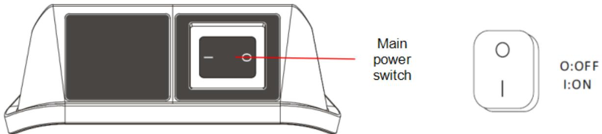
Main power switch : Interrupteur Principal
