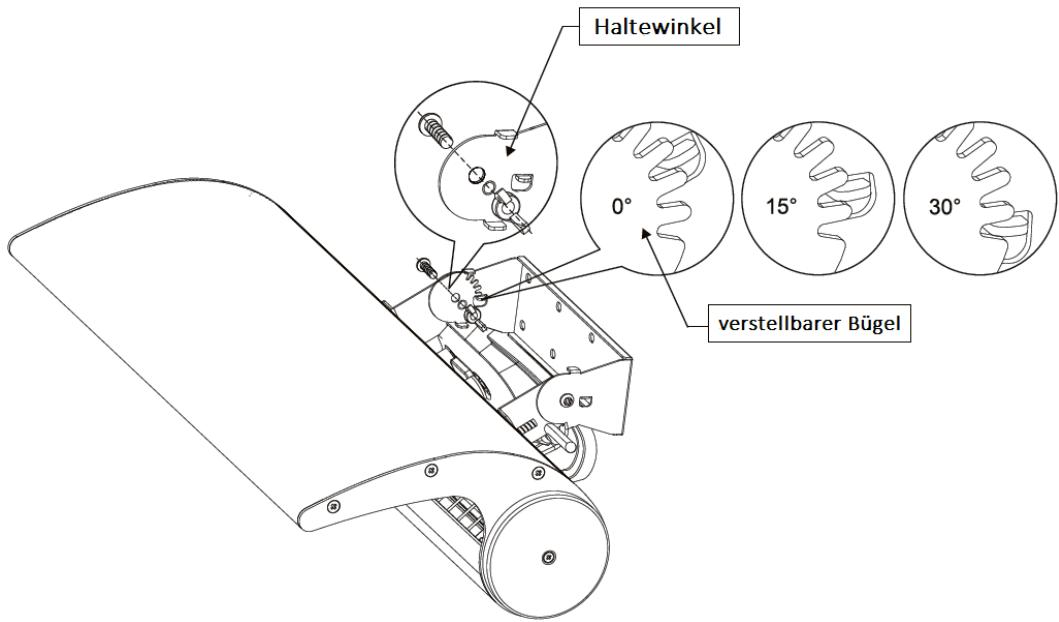
3.2 Passen Sie den Heizwinkel an ( $0^\circ$ ,  $15^\circ$ ,  $30^\circ$ ) ;
