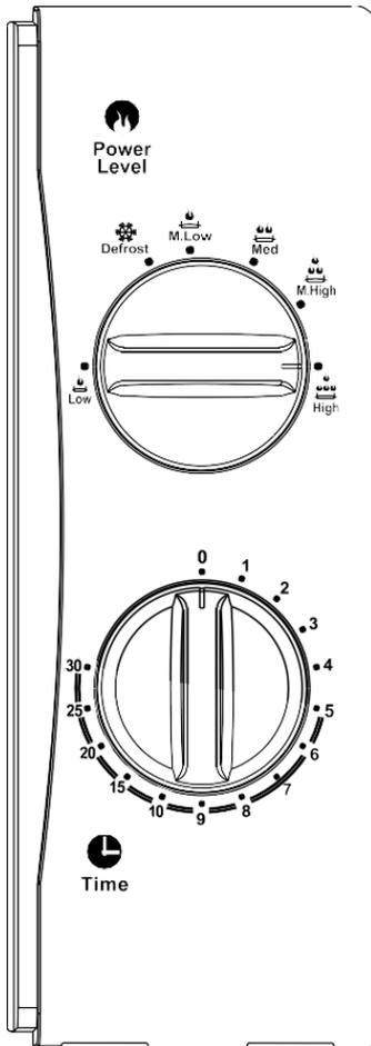
El panel de control consta de dos perillas de función. Una es la perilla del temporizador y la otra es la perilla del selector de potencia.
