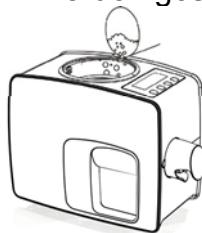
3. Sluit de deksel van de hopper en plaats de oliebak op zijn plek.
