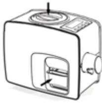
**Hinweis :** Der Trichterdeckel muss in der richtigen Position sein, sonst funktioniert die Maschine nicht.
