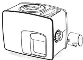
3. Schrauben Sie die Welle mit dem beiliegenden Spezialschlüssel gegen den Uhrzeigersinn ab und nehmen Sie dann den äußeren Teil heraus.
