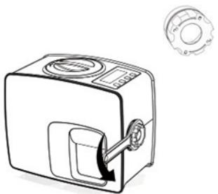
4. Limpie el eje de extrusión y todo el mecanismo con una toalla de cocina o un paño suave. No debe utilizar ningún tipo de detergente o limpiadores corrosivos.
