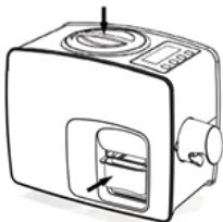
**Nota:** esta máquina sólo funciona si la tapa del embudo está cerrada en la posición correcta.
