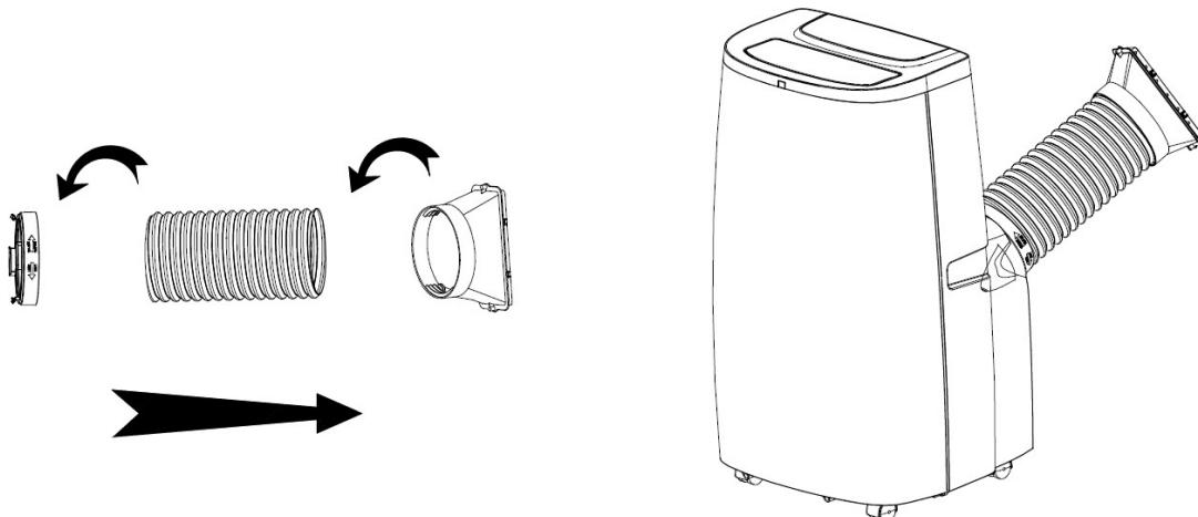
A. Estrarre il tubo di scarico, il suo connettore e l'adattatore, per rimuovere il sacchetto di plastica.
