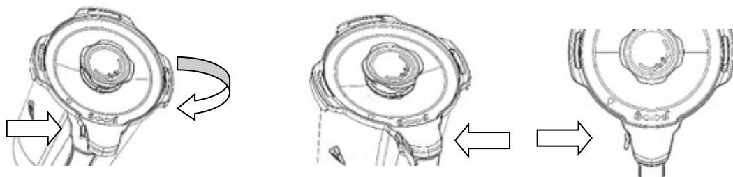
Placez le bocal sur le bloc-moteur dans le bon sens et fixez-le correctement, sinon le moteur ne peut pas démarrer.
