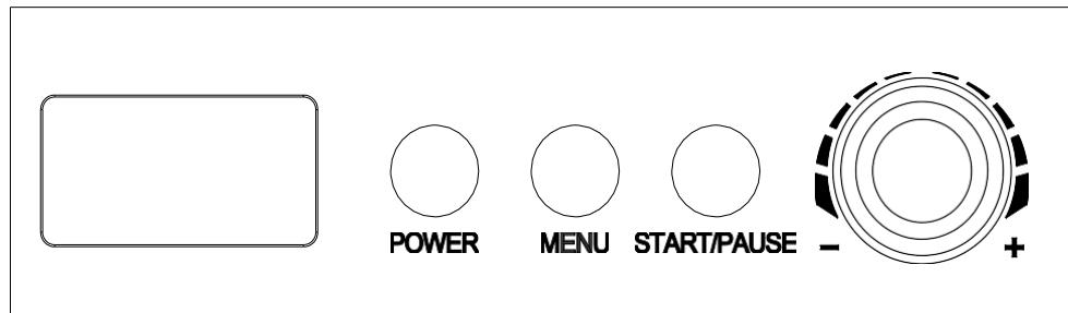
**[POWER]:** Nach dem Einschalten betritt die Maschine den Standby-Modus. Drücken Sie dann auf die **[POWER]** Taste, um den Einstellungs-Modus zu betreten; der LCD-Bildschirm wird "60: 00" anzeigen und das Hintergrundlicht wird angehen. Wenn das Gerät nicht bedient wird, geht das Licht in 15 Sekunden aus; drücken Sie dann auf die **[POWER]** Taste erneut; die Maschine kann wieder in den Standby-Modus gehen.
