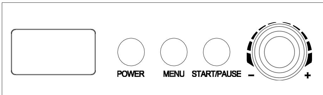
**[POWER]** : après la mise sous tension, la machine passe en mode veille. Appuyez alors sur le bouton **[POWER]** pour définir les réglages ; l'écran affichera 60 : 00 " et allumera la lumière d'arrière-fond. Si aucune autre opération n'est engagée, la lumière s'éteindra 15 secondes plus tard; appuyez alors sur le bouton **[POWER]** de nouveau : la machine peut revenir en mode veille.
