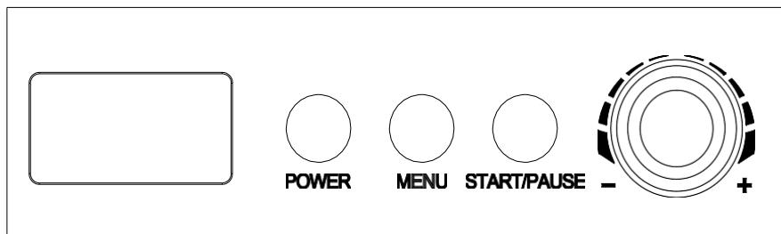
**[POWER]:** Cuando conecte el enchufe al tomacorriente, la máquina entra al modo de espera. Presione el botón **[POWER]** para entrar al modo de ajuste y la pantalla LCD mostrará "60:00" y encenderá la luz de fondo. Si no se realiza otra operación, la luz de fondo se apagará 15 segundos después. Presione el botón **[POWER]** nuevamente para volver al modo de espera.
