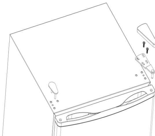
Passaggio 2: smontare la cerniera della porta inferiore e i piedini allentando le viti.
