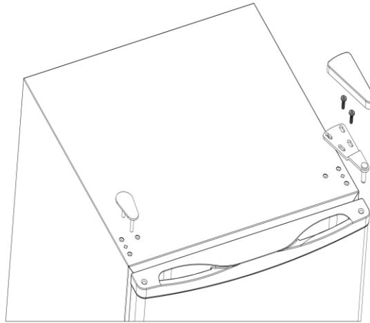
**Schritt 2:** Demontieren Sie das untere Türscharnier und die FüÙe, indem Sie die Schrauben lösen.
