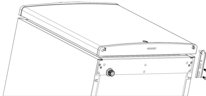
**Schritt 3:** Verschieben und befestigen Sie das untere Türscharnier einschließlich der FüÙe mit den Schrauben.
