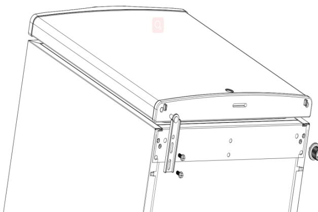
**Stap 4:** Verwijder het bovenste scharnier en de afdekking van rechts naar links. Bevestig het bovenste deurscharnier met de schroeven en bedek het plastic deksel en het scharnierdeksel.
