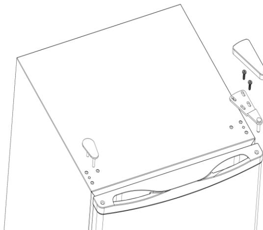
Paso 2: Desmonte la bisagra inferior de la puerta y los pies aflojando los tornillos.
