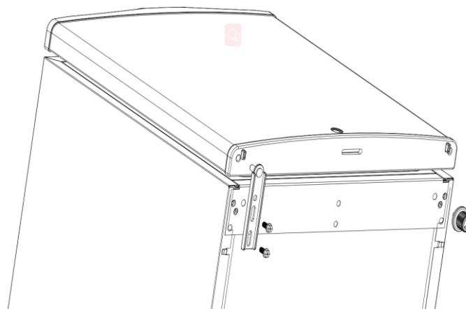
**Schritt 4:** Entfernen Sie das obere Scharnier und die Abdeckung von rechts nach links. Befestigen Sie das obere Türscharnier mit den Schrauben und decken Sie die Kunststoffabdeckung und die Scharnierabdeckung ab.
