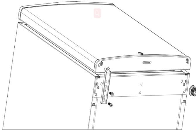
**Paso 4:** Retire la bisagra superior y la cubierta del lado derecho al lado izquierdo. Fije la bisagra superior de la puerta con los tornillos y cubra la cubierta de plástico y la cubierta de la bisagra.
