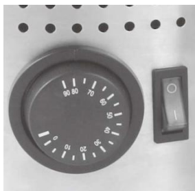
Wyłącznik główny i termostat główny
