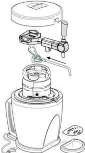
3. Quando la temperatura ambiente è 25°C e il fusto Heineken è posizionato, accendere l'unità con corrente continua o corrente alternata per 48 ore, la temperatura della birra scenderà e si manterrà sui 3~6°C. (3°C significa che il refrigeratore è in funzione, 6°C significa che è fermo)
