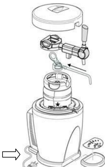
3. A una temperatura ambiente de 25 °C, una vez que coloque el tonel y encienda el aparato ya sea conectado a CD o CA, la cerveza se enfriará a 3-6 °C en 48 horas y se mantendrá siempre a esa temperatura. Si la temperatura está en 3 °C significa que el compresor está funcionando y en 6 °C significa que el compresor está parado, en modo estacionario.
