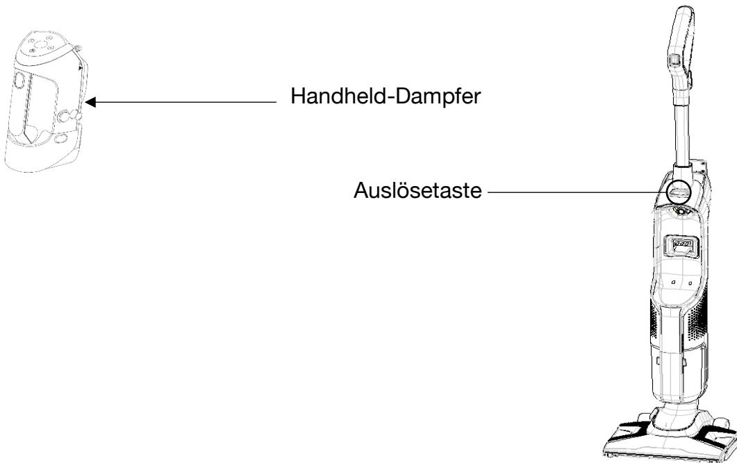
(Installationsmethode: Halten Sie Ihre Hand auf dem Handheld-Dampfer, schieben Sie diesen in die Richtung des angezeigten Pfeils, und befestigen Sie diesen in der entsprechenden Position der Grundlage.)
