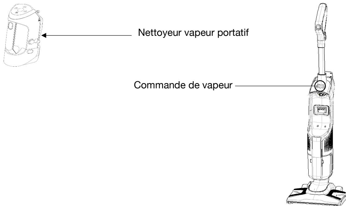
Mode d'installation : tenez le nettoyeur vapeur par la poignée, placez-le selon la direction indiquée par la flèche et fixez-le dans le logement de la partie principale de l'appareil.
