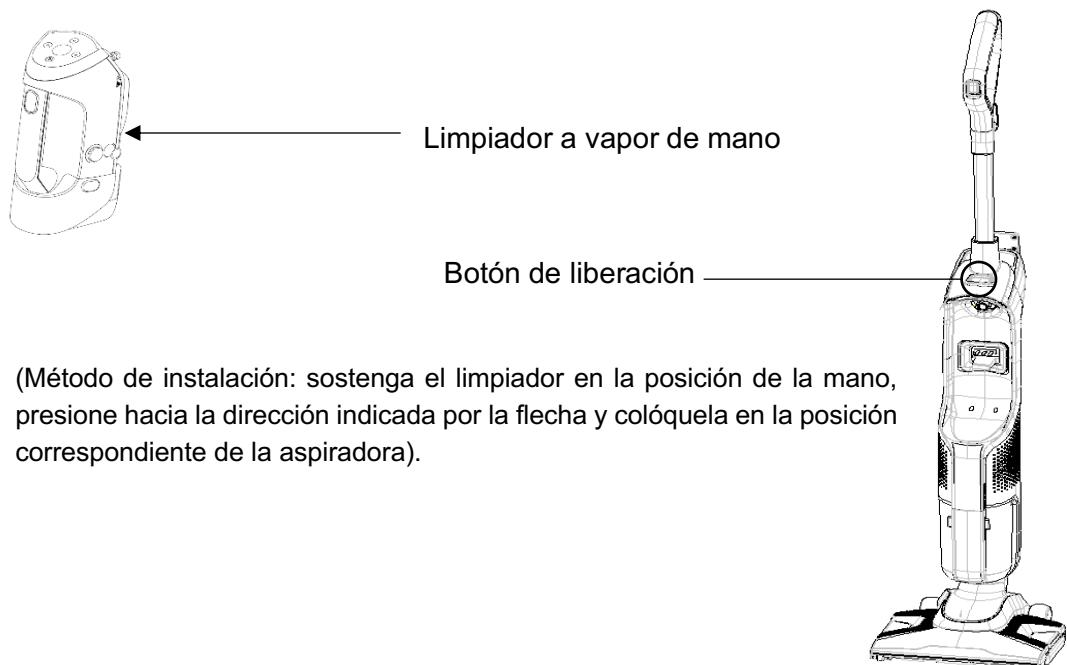
(Método de instalación: sostenga el limpiador en la posición de la mano, presione hacia la dirección indicada por la flecha y colóquela en la posición correspondiente de la aspiradora).
